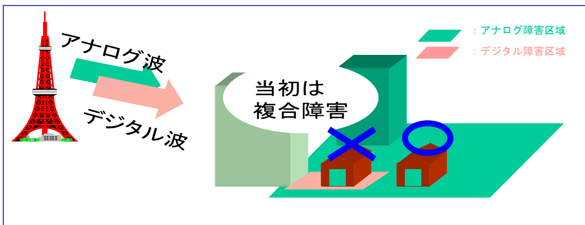
図2 デジタル化による単独障害モデル
